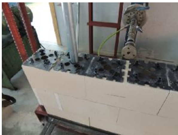
Fotografía del dispositivo y del montaje de la fábrica para realizar el ensayo a flexión el 27/07/2015 con bloques de hormigón fabricados por DULMEK SA.
