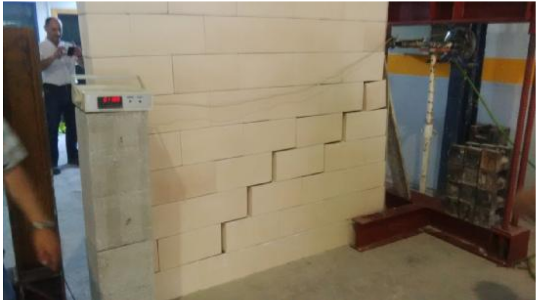
Imagen de la rotura final de un paño lateral de la fábrica de bloques ensayada.
