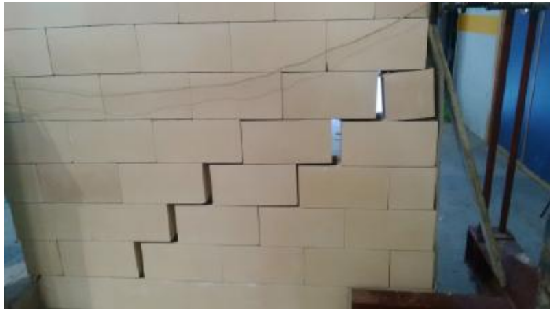
Detalle de las líneas de rotura en un paño lateral de la fábrica de bloques ensayada.
