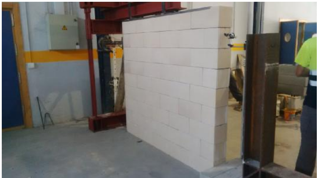
Vista de la disposición del micrómetro para conocer el desplazamiento horizontal de la hilada superior de la fábrica de bloques.
