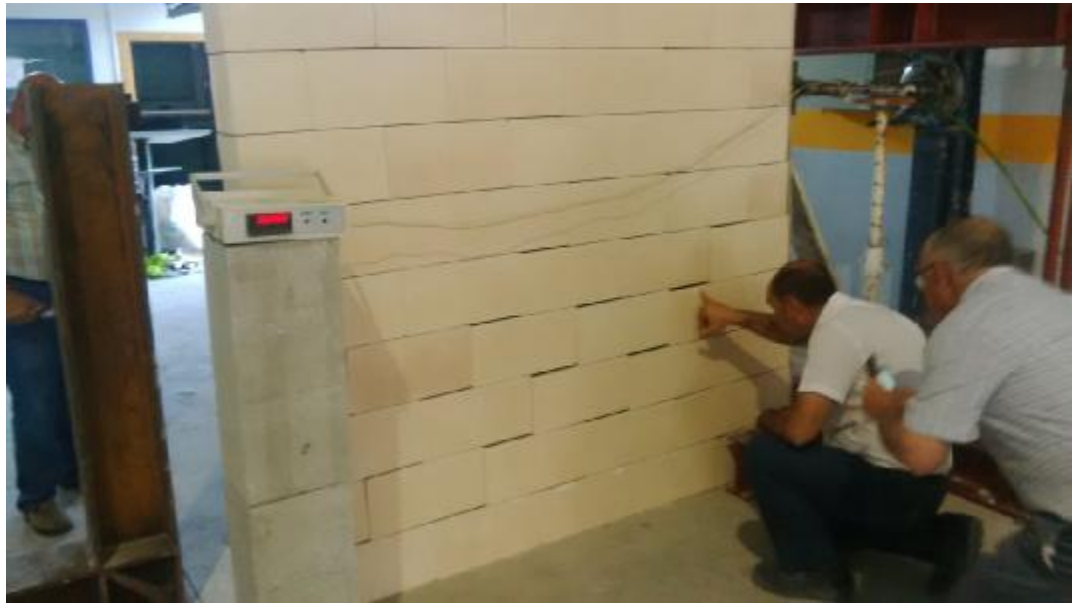
Efecto en las juntas de los bloques de los paños laterales de la fábrica de bloques del Inicio de la rotura en el paño vertical en cuyo extremo superior se estaba aplicando la carga.
