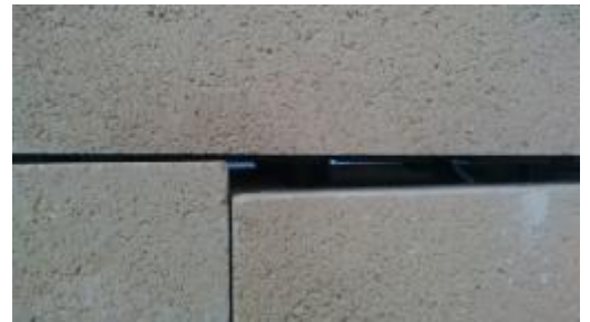
Detalles del estado de las juntas abiertas en un paño lateral de la fábrica de bloques al iniciarse la rotura en el paño vertical en cuyo extremo superior se estaba aplicando la carga.
