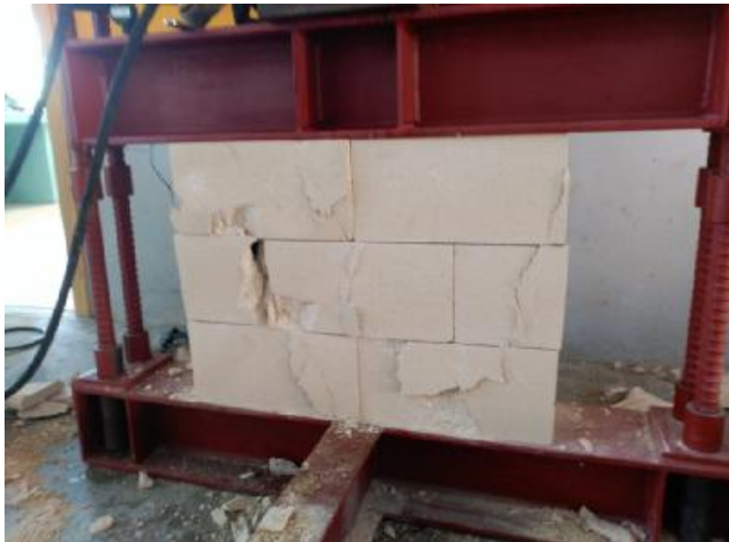
Vista de la rotura del paño vertical frontal
