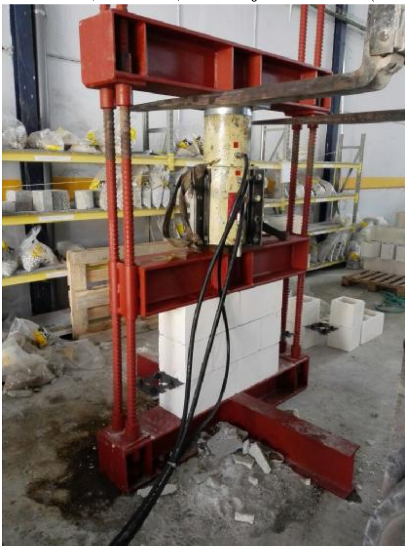
Fotografía del dispositivo dispuesto para realizar el primer ensayo a compresión de una muestra de la fábrica realizada con bloques de hormigón fabricados por INDUSTRIAS AUDIOLIS.
