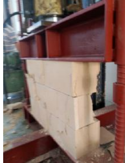
Vista de la rotura del paño vertical derecho
