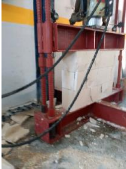
Vista de la rotura del paño vertical izquierdo
